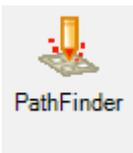
Ouvre le module Pathfinder pour définir les séquences de coupe, créer des ponts entre les pièces, générer un programme CNC etc...
