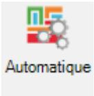
Imbrique automatiquement les composants dans le stock, les chutes et les tôles achetées en utilisant la [Mise en Tôle automatique](#)
